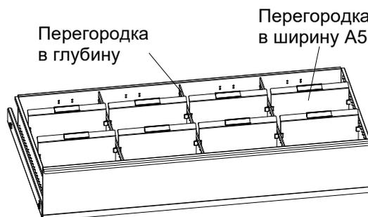
Ящик с тремя перегородками в глубину - четыре ячейки шириной 229 мм.
